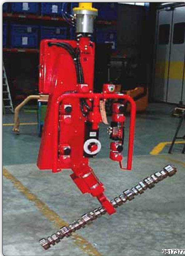
Манипулятор с пневматическими зажимами для захвата, наклона и поворота трансмиссионных валов.
