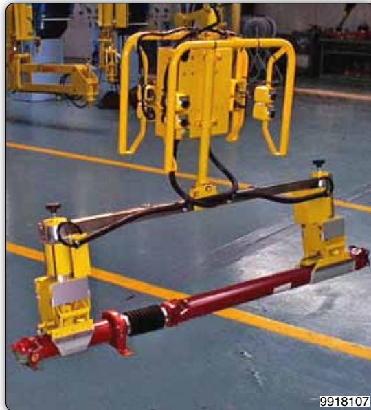
Манипулятор с двойным зажимным захватом с регулируемыми губками для захвата трансмиссионных валов.
