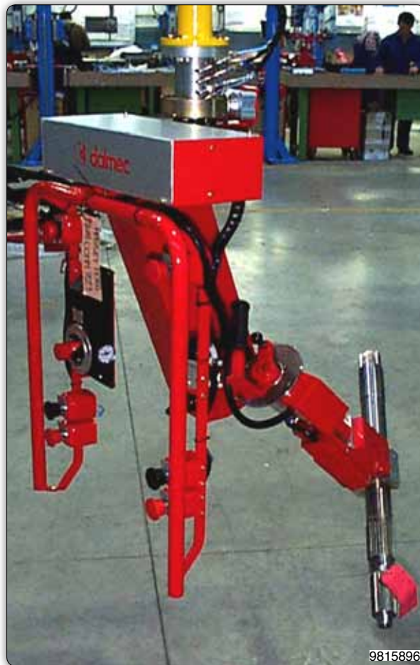
Манипулятор с пневматическими зажимами для захвата, наклона и поворота трансмиссионных валов.
