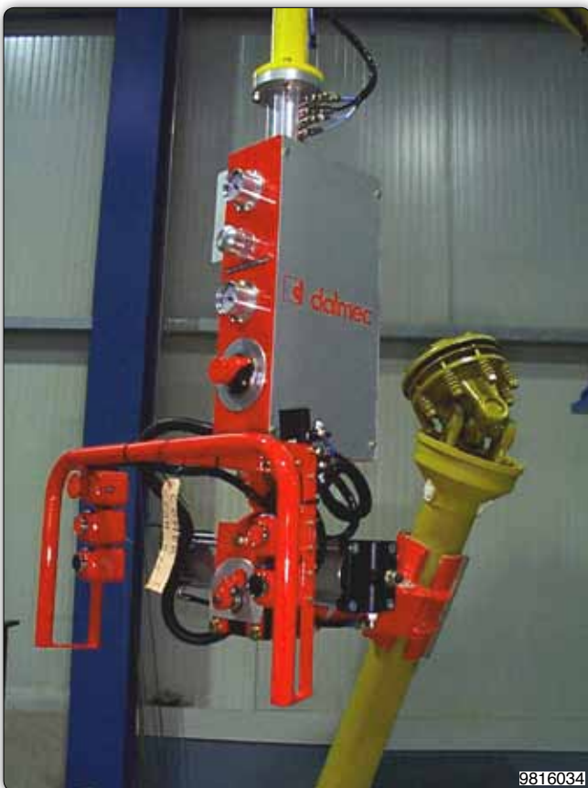
Манипулятор с пневматическим зажимным поворотным захватом для трансмиссионных валов.
