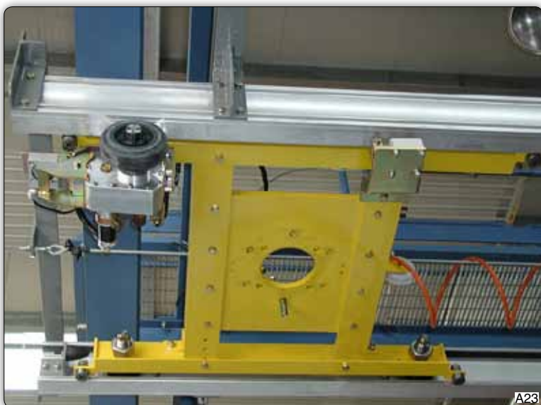
Тележка в комплекте с роликами на подшипнике для ручного перемещения по ходовому пути и с плитой с отверстиями для крепления манипулятора.
