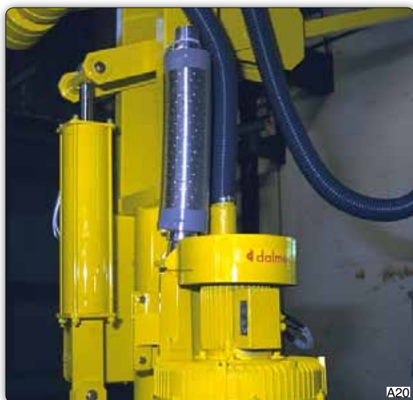
А20 Глушитель, установленный на выпускной трубе генератора, предназначенный для уменьшения уровня шума на 3 дБ, примерно с 74 до 71.
