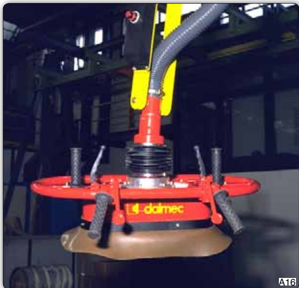
А16 Присос для мешков оборудованный резиновой губой и расположенными внизу элементами управления.
