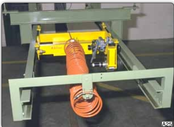
Станция сжатого воздуха для питания манипулятора вдоль всего существующего ходового пути, состоящая из воздушной спиральной трубки высокого давления, поддерживающего троса и направляющего шкива.
