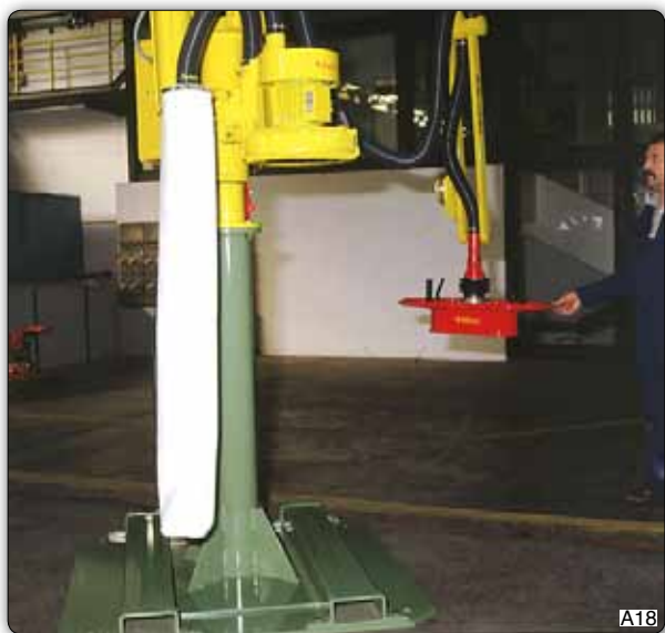
А18 Рукавный фильтр, прикрепленный к выпускной трубе генератора и предназначенный для улавливания всасываемой пыли.
