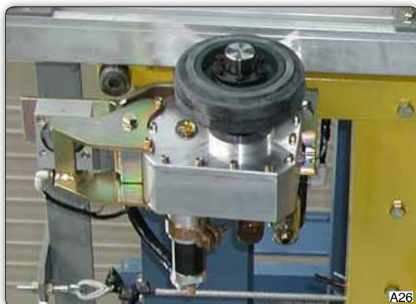
Пневматический привод тележки передвижения, состоящий из узла пневматического мотор-редуктора с приводным колесом из резины, укомплектованный фильтром-смазчиком, регулятором давления, кнопками управления возвратно-поступательным движением.
