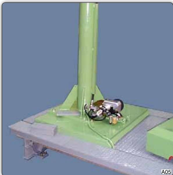
Встраиваемая в пол площадка с пневмоприводом для перемещения манипулятора.
