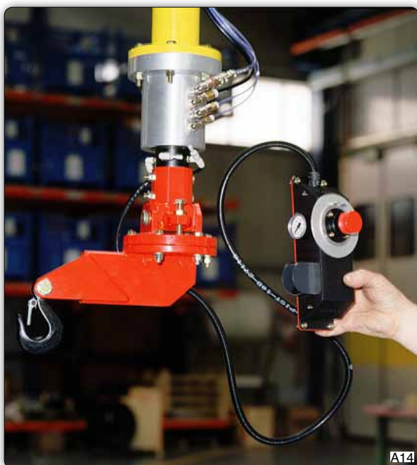
Фланец для возможности подсоединения приспособлений для захвата, изготовленных пользователем и применяемых на манипуляторах Partner в специальном исполнении.
