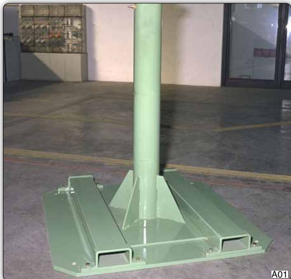
Самоустойчивое основание манипулятора, предназначенное для его транспортировки при помощи автопогрузчика.
