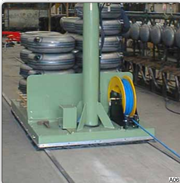
Самоустойчивая несущая тележка манипулятора на рельсах удлиненной модели для транспортировки перемещаемых изделий.
