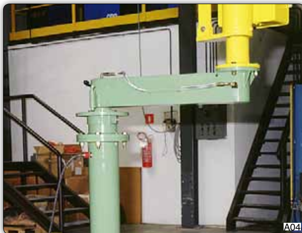
Стойка со смещенной осью для увеличения рабочей площади манипулятора, укомплектованная механическим тормозом размещенным через каждые 45°.
