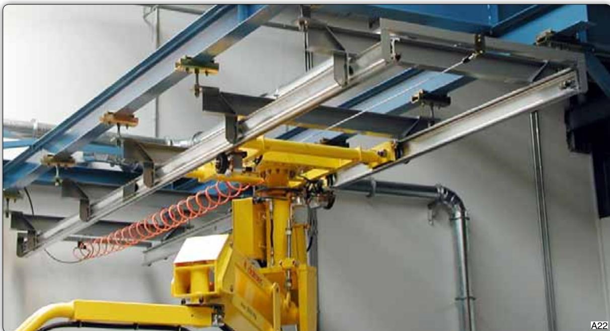
Подвесной ходовой путь, состоящий из 2-х двутавровых балок, расположенных параллельно одна к другой и изготовленных из алюминиевого сплава со стальным треком качения и усиливающими соединительными кронштейнами, расположенными через каждые 2 м, укомплектованный также концевыми буферами.
