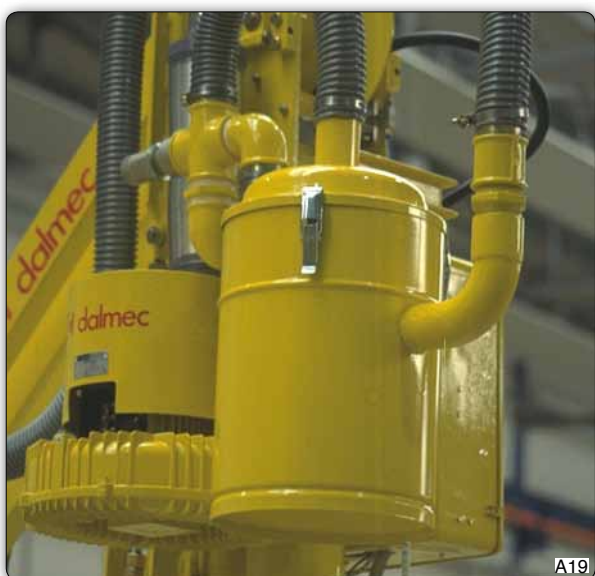
А19 Цилиндрический фильтр на всасывающем трубопроводе вакуумного насоса, предназначенный для улавливания всасываемой пыли.
