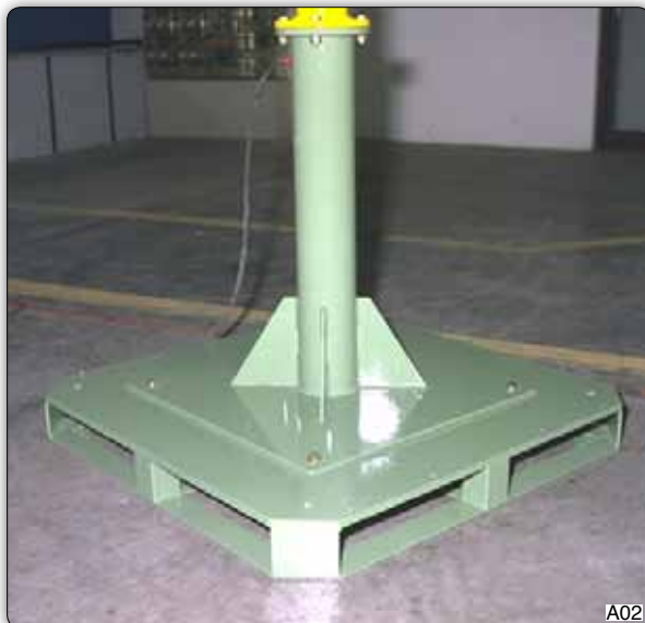
Самоустойчивое основание манипулятора, предназначенное для его транспортировки при помощи тележки для перевозки поддонов.
