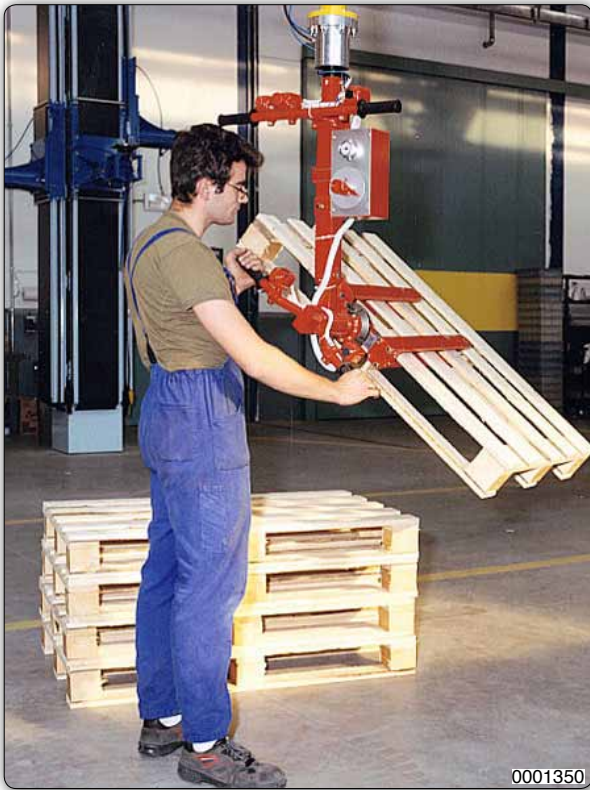
Манипулятор с вилчатым приспособлением и ручным переворотом на 180°, предназначенный для захвата и поворота поддонов.
