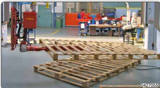
Приспособление для захвата и поворота при помощи пневмопривода для специальных поддонов.
