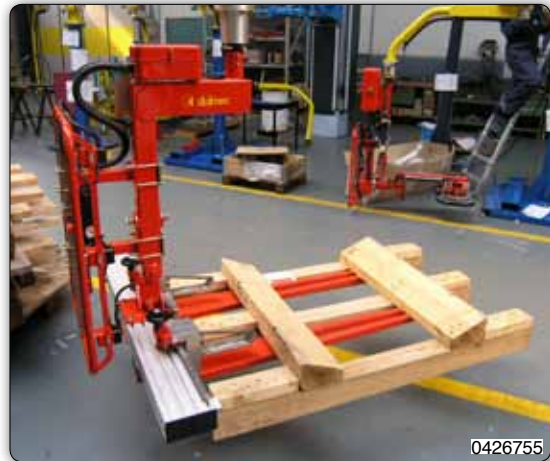
Приспособление с регулируемыми вилами, с поворотом груза при помощи пневмопривода и с телескопическими элементами управления.
