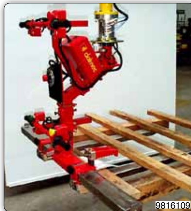
Приспособление с регулируемыми вилами и устройством блокировки.
