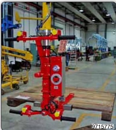
Вилчатое приспособление с ручным поворотом груза.
