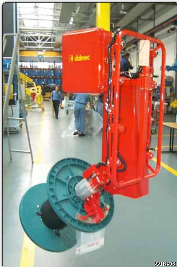
Манипулятор с раздвижным патроном для вставки во внутреннее отверстие катушки и с пневмоприводом для наклона катушки на 90°.
