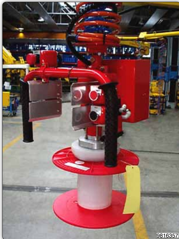
Манипулятор с раздвижным патроном, вставляемым во внутреннее отверстие катушки.
