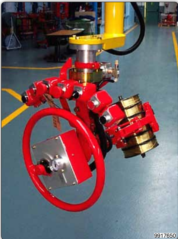
Манипулятор с системой зажимов для захвата нескольких катушек одновременно и с ручным поворотом на 90°.
