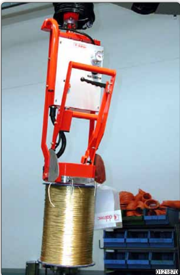
Манипулятор с механизмом для захвата катушки за фланцы, снабженный зубчатым стационарным сегментом с пневмоприводом и ручным поворотом катушки с вертикального положения в положение наклона на 60°.
