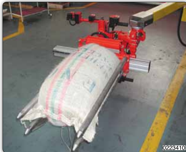
Манипулятор с пневматическим приспособлением с плоскими зажимами.
