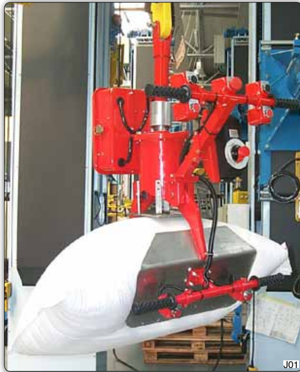
Манипулятор с пневматическим приспособлением с плоскими зажимами.
