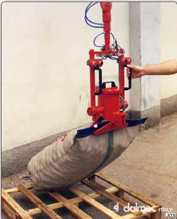
Манипулятор с приспособлением для захвата с плоскими зажимами, предназначенный для захвата и поворота мешков с горизонтального положения в вертикальное и наоборот.
