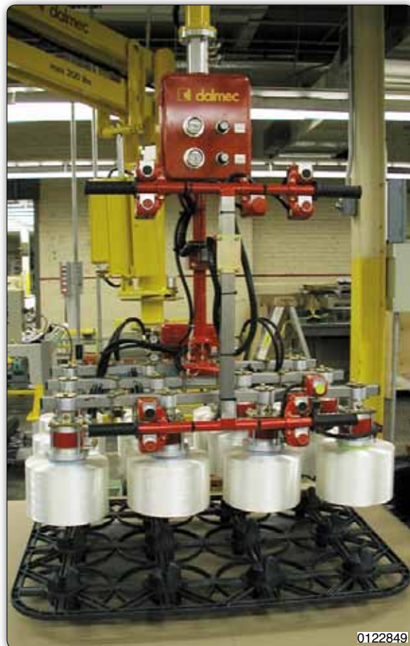
Манипулятор с оправки для одновременного захвата из двенадцати катушек.
