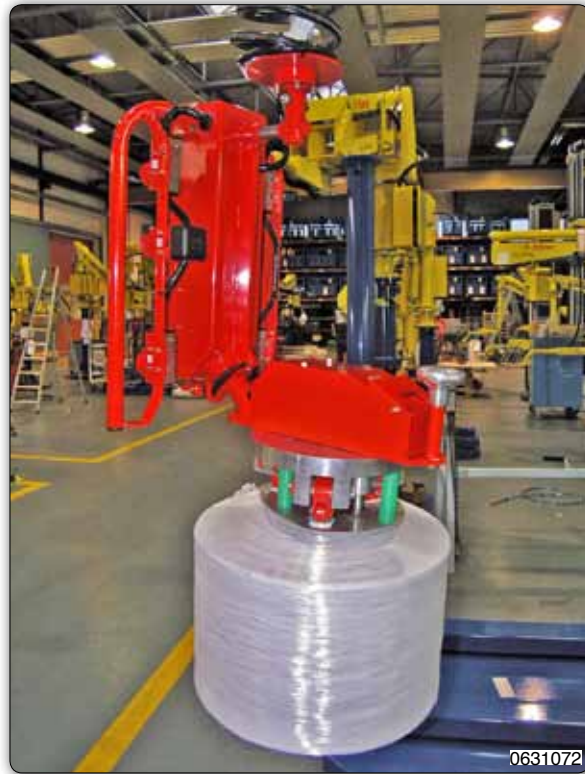
Манипулятор Partner типа RMC в исполнении на стойке оборудованный раздвижным патроном. Манипулятор позволяет осуществлять наклон катушки на 90° и оборудован мессдозой для контроля веса перемещаемой катушки.
