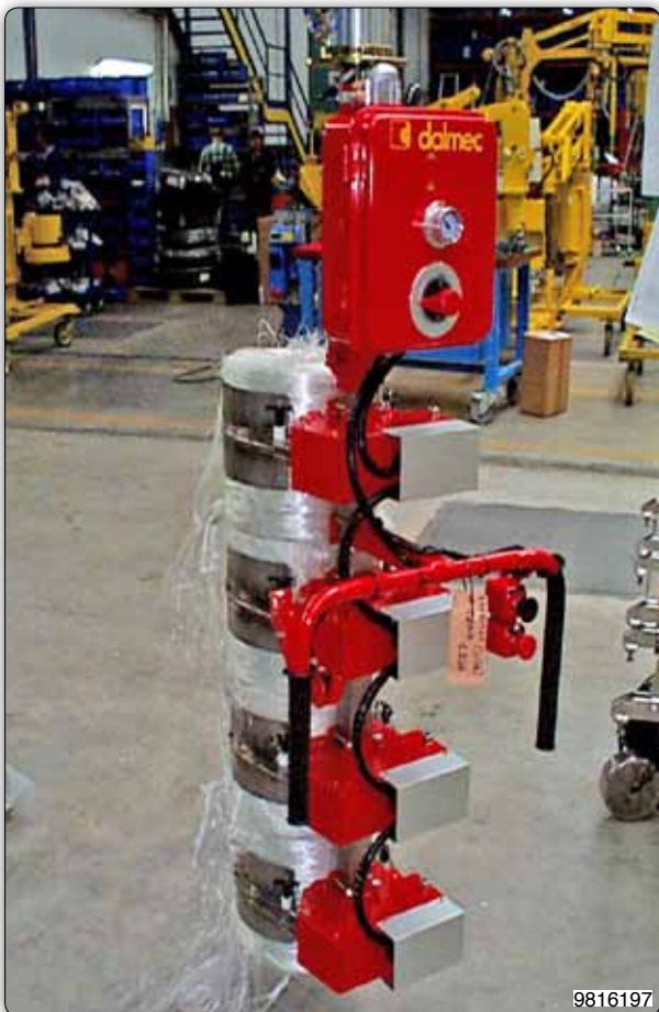
Манипулятор с зажимными приспособлением для захвата, состоящим из 4-х узлов зажимных пластин, предназначенным для одновременного захвата нескольких катушек стекловолкна.
