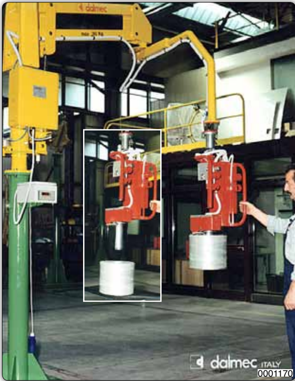
Манипулятор Partner типа RMC в исполнении на стойке оборудованный раздвижным патроном. Манипулятор позволяет осуществлять наклон катушки на 90° и оборудован мессдозой для контроля веса перемещаемой катушки.
