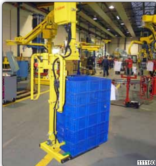
Манипулятор с вильчатым захватом для перемещения ящиков.
