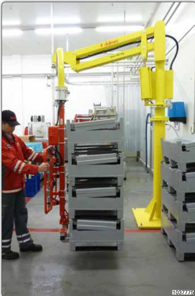
Манипулятор Partner типа PMS в исполнении на стойке и самоустойчивом основании, оборудован зажимным приспособлением для захвата и предназначенный для перемещения ящиков.
