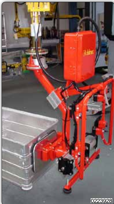
Манипулятор с вильчатым захватом для перемещения металлических ящиков.
