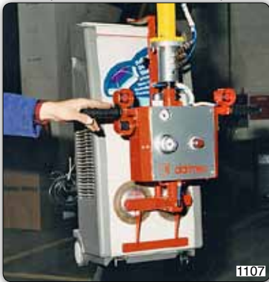
Приспособление с присосами для захвата и перемещения кондиционеров.
