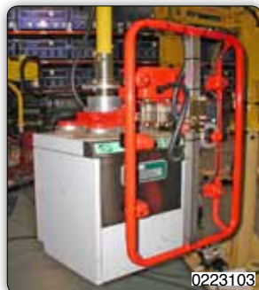
Приспособление с присосами для захвата и перемещения электроплит.
