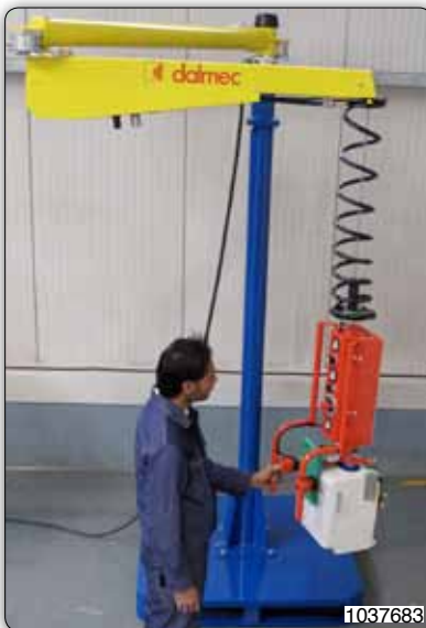
Манипулятор Posivel PVC Приспособление с присосами для захвата и перемещения компрессоров холодильника.
