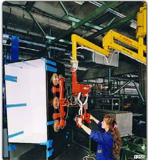
Манипулятор Partner PMS в подвесном передвижном исполнении с приспособлением для захвата с присосами для перемещения корпусов холодильников.
