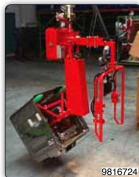
Манипулятор с пневматическим зажимом для захвата и наклона внутренней ванны посудомоечной машины.
