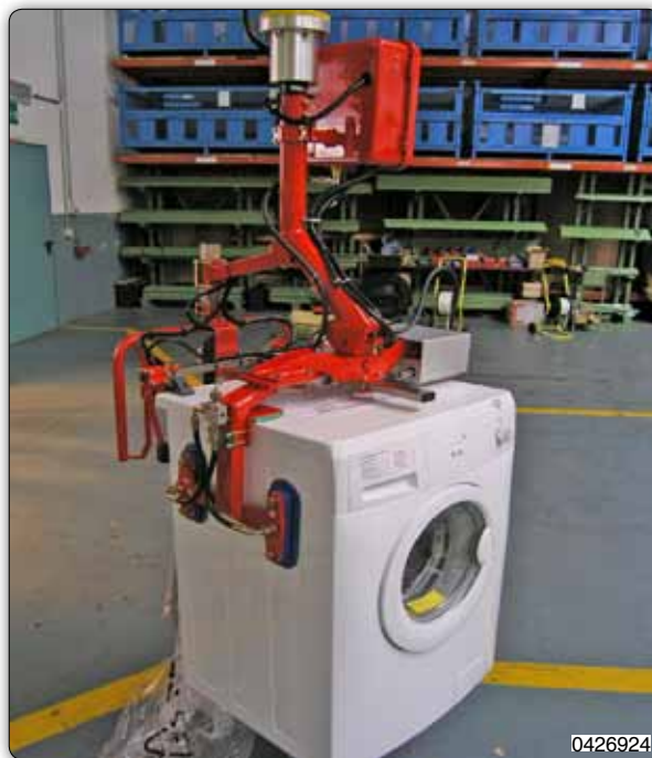
Манипулятор с приспособлением для захвата с присосами для перемещения стиральных машин.
