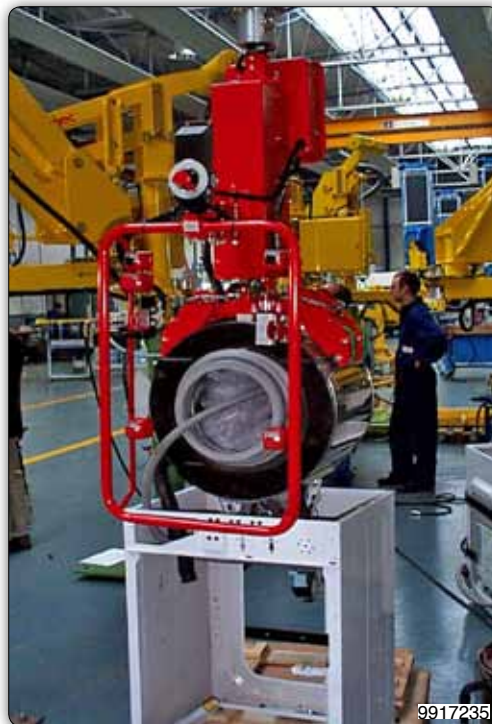
Зажимное пневматическое приспособление для захвата, поворота и заправки корзины стиральной машины в ее корпус сверху.
