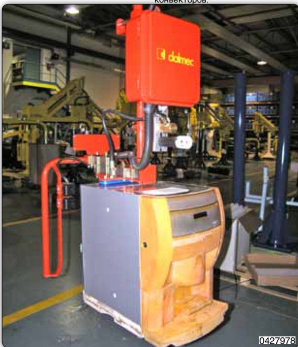
Манипулятор с приспособлением для захвата с присосами для перемещения торговых автоматов.
