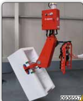
Приспособление с присосом для захвата панелей теплообменников для холодильных камер.
