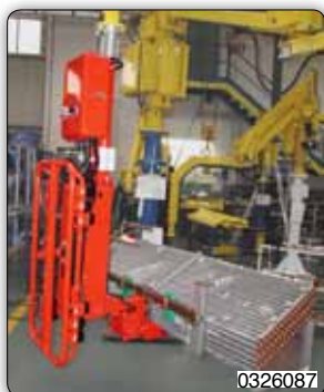
Зажимное пневматическое приспособление для захвата и поворота на 90° змеевиков кондиционеров.
