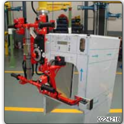
Вильчатый захват для перемещения корпусов стиральных машин.
