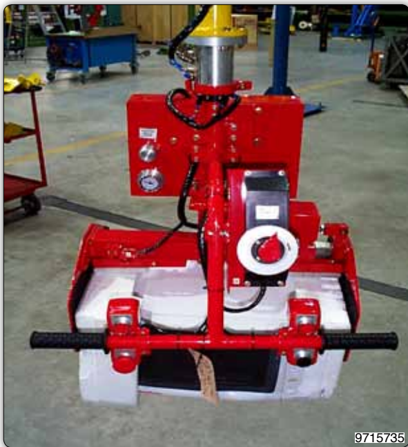
Манипулятор с зажимным приспособлением для захвата и перемещения микроволновых печей.
