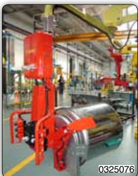
Зажимное пневматическое приспособление для захвата и поворота на 90° корзин стиральных машин.
