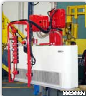
Пневматическое приспособление с присосами для перемещения и наклона на 90° тепловых конвекторов.
