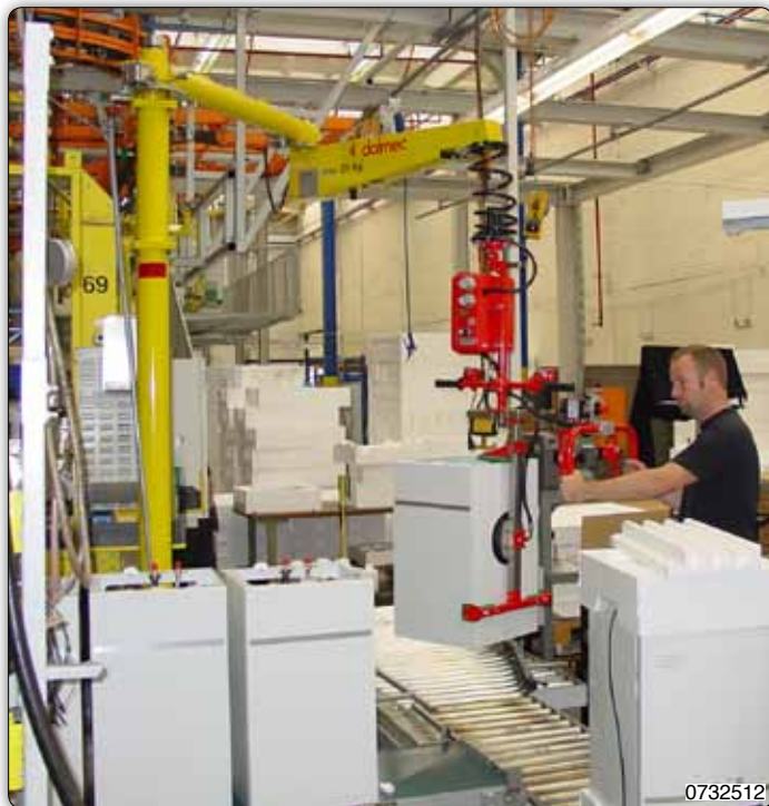
Манипулятор Posivel PVC Приспособление с присосами для захвата и перемещения электробытовые приборы.
