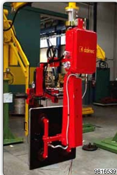
Манипулятор с приспособлением для захвата с присосами для перемещения верхних плит электроплиты.
