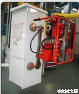
Пневматическое приспособление с присосами для перемещения и поворота на 90° холодильников.
