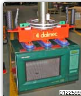
Приспособление с присосами для захвата и перемещения микроволновых печей.
