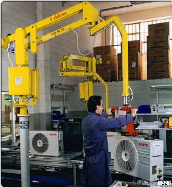
Манипулятор Partner типа PMS в исполнении на стойке, оборудованный приспособлением для захвата с присосами для перемещения кондиционеров.
