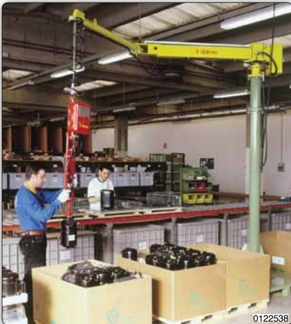
Манипулятор Posifil типа PFC в исполнении на стойке, оборудованный приспособлением для захвата с присосами для перемещения компрессоров холодильника.
