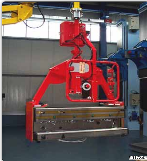
Манипулятор с зажимным приспособлением для захвата и перемещения кофейных автоматов.
