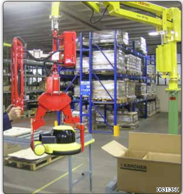
Манипулятор Partner типа PMS в исполнении на стойке, оборудованный вильчатым захватом для перемещения газонокосилки
