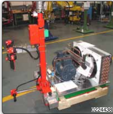
Вильчатый захват для перемещения узлов холодильника (компрессора – панели теплообменника).
