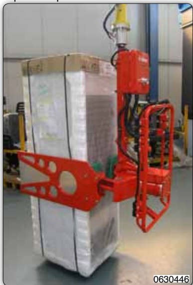
Манипулятор Partner с зажимным приспособлением для перемещения корпусов холодильников упаковке или без нее.
