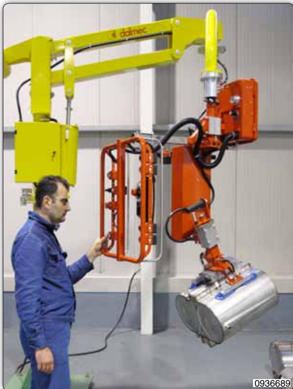
Манипулятор Partner типа RMC в исполнении на стойке с приспособлением с присосами "вентури" ("Venturi") для захвата, ручного поворота и перемещения бойлеров.
