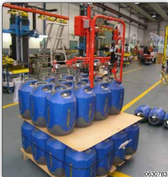
Манипулятор с приспособлением с профильными плоскими для захвата одного или двух баллонов.
