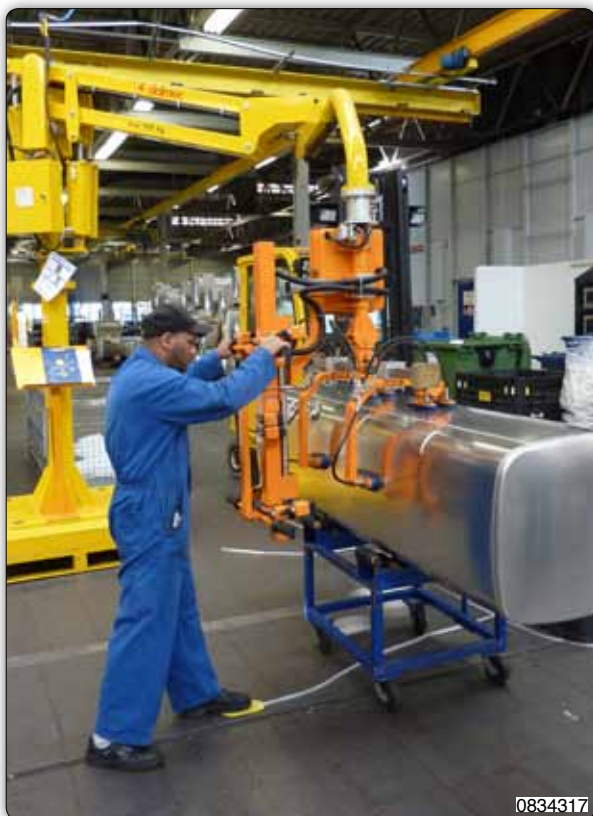
Манипулятор с приспособлением с присосами ("Venturi") для захвата и перемещения ресиверов.
