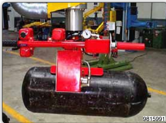
Манипулятор с приспособлением с регулируемыми присосами ("Venturi") для захвата, перемещения и позиционирования баллонов для сжиженного газа в автомобиле.
