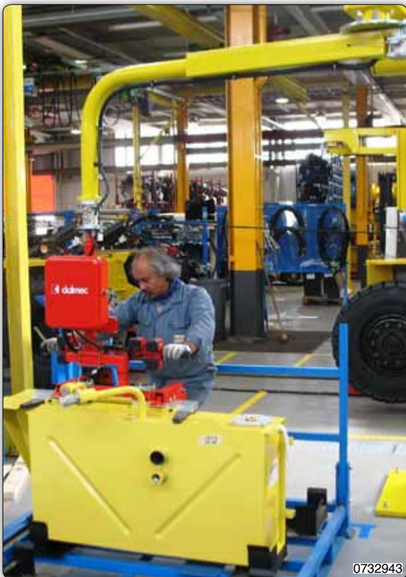
Манипулятор с пневматическим захватом для захвата и перемещения ресиверов для промышленных кораблей.
