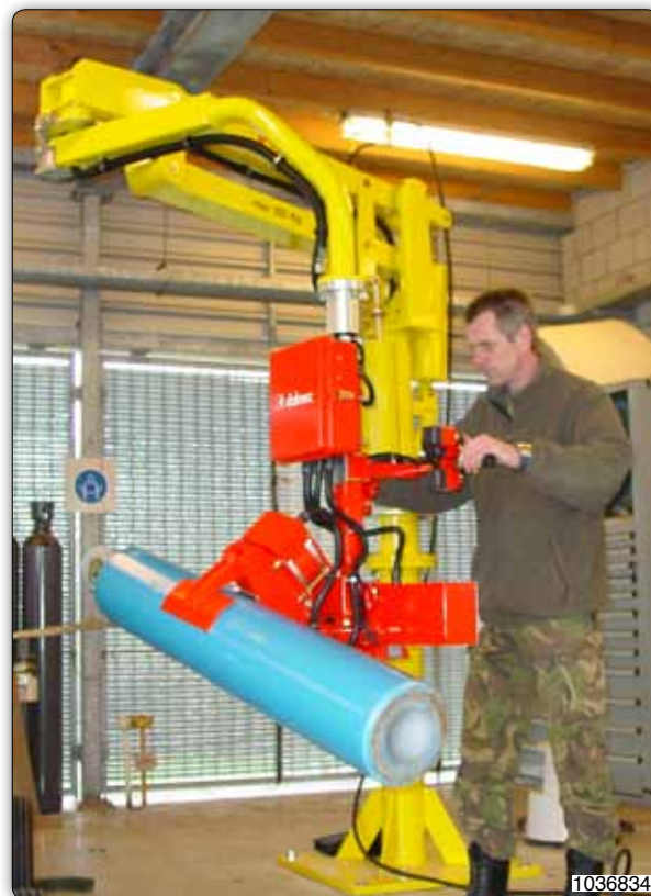
Манипулятор с пневматическим захватом, наклоном на 90° при помощи пневмопривода и ручным переворотом на 180° баллонов различных размеров.
