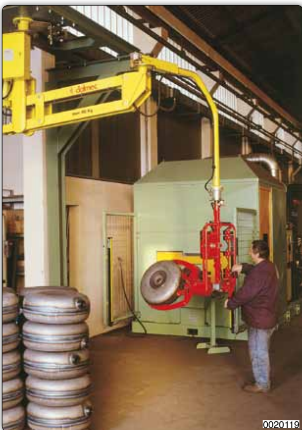
Манипулятор с пневматическими зажимами для захвата, наклона и перемещения тороидальных баллонов.
