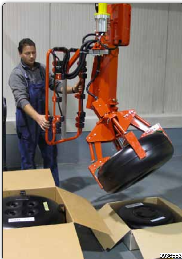
Манипулятор с пневматическими зажимами для захвата, наклона и перемещения тороидальных баллонов.
